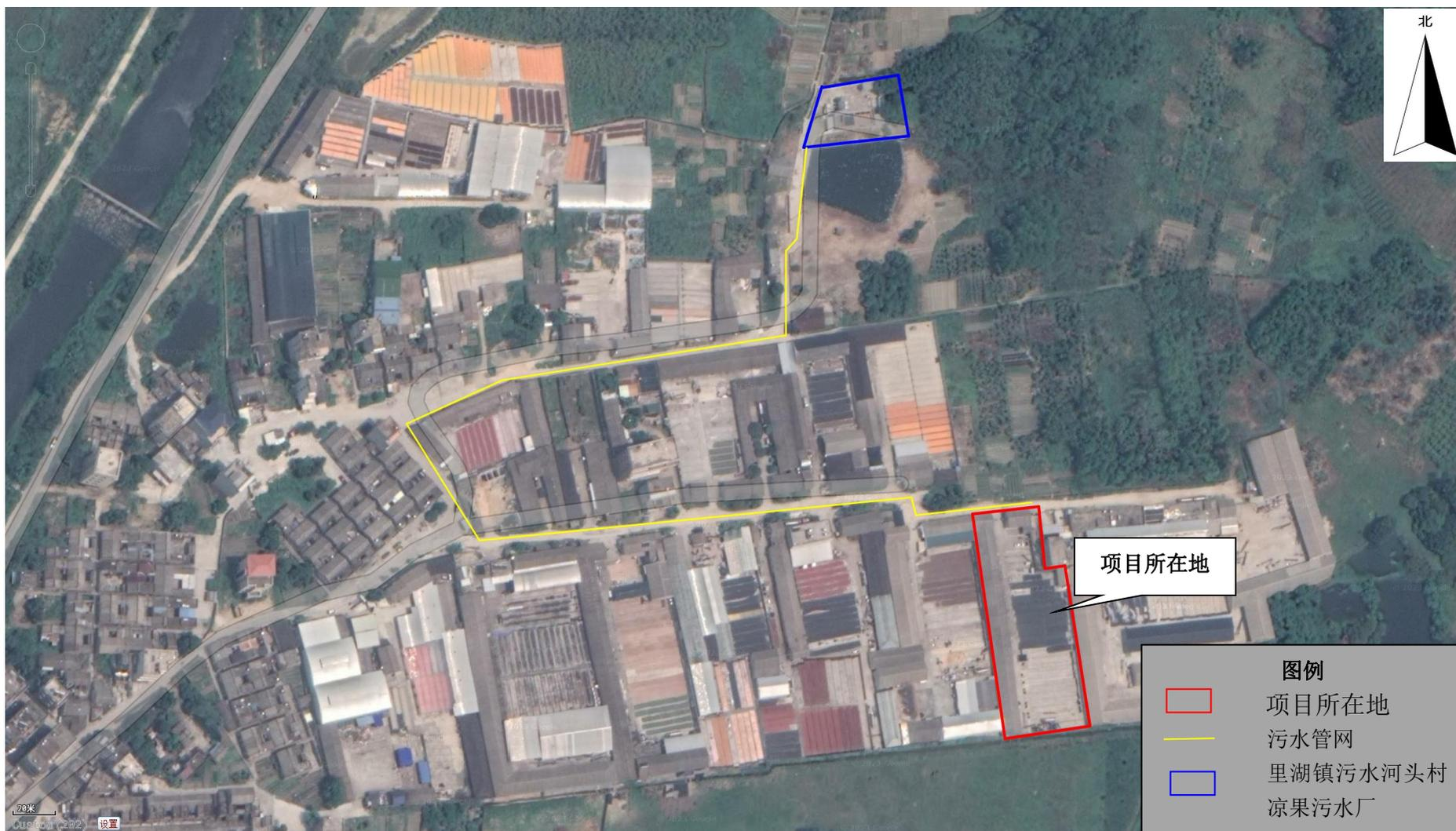
附图 12 纳污水厂的污水管网图
