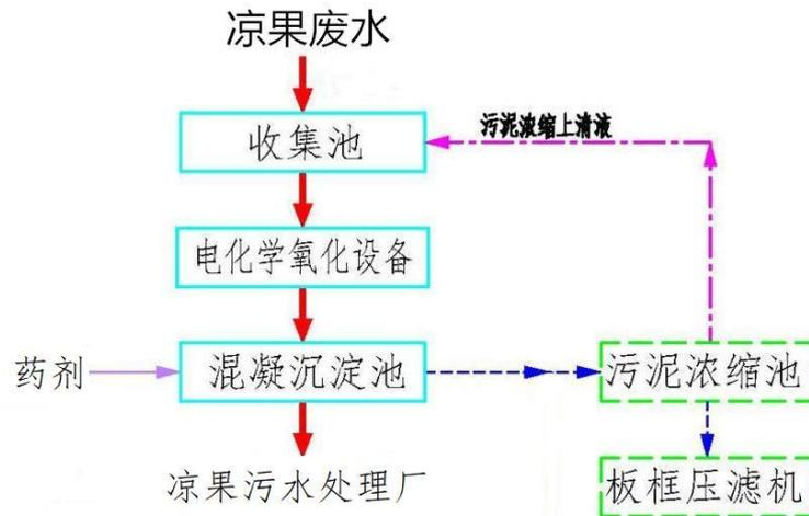
图 4-1 项目废水处理工艺流程图
